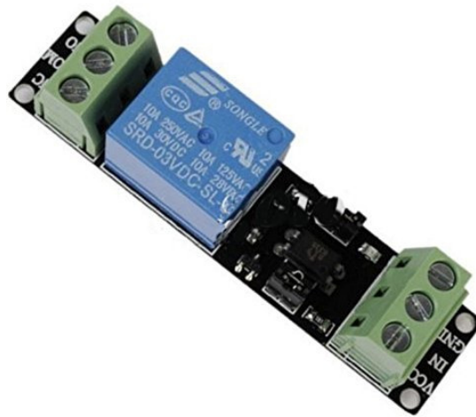
Joonis 7. Relee SRD-DC03V-SL-C [23].
