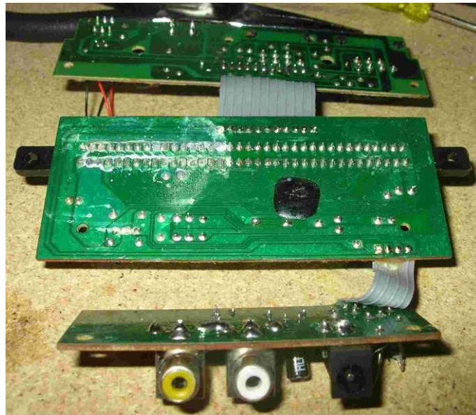
Joonis 3. Veekahjustused trükkplaadil [3]
