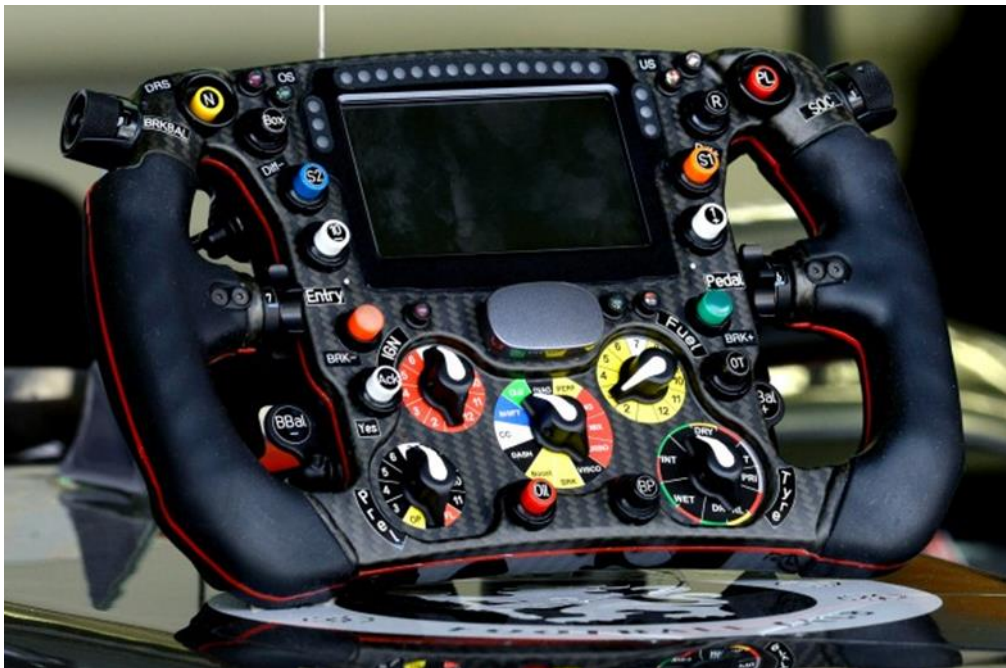
Joonis 1. Sauberi vormeli näidikuteplokk koos rooliga [1].
