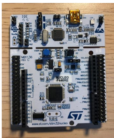
Joonis 2. Arendusplaat STM32F446RE
